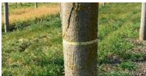
Dendrometer zur Messung des Baumwachstums. Ref: E Jaurez
