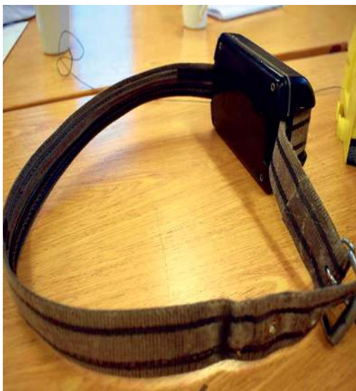
Kuhhalsband mit der Sensoreinheit.
